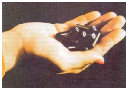
Rys. 8. Pastyłki paliwa jądrowego [7]
